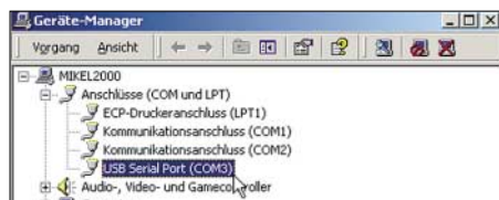
Bild 9: Im Gerätemanager – hier unter Windows 2000 – lesen Sie den zugewiesenen COM-Port ab.
