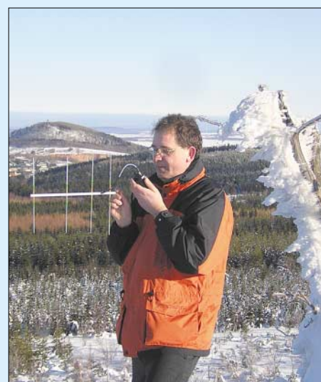
Bild 12: Durch Einsatz einer kleinen Yagi, die abzüglich Kabel- und Steckerverlusten noch einen Antennengewinn von G_{\text{Ant, isotrop}} = 5 auf dem 70-cm-Band aufweist, werden aus den 2 W Sendeleistung des Handfunksprechers 10 W EIRP. Fotos: DJ5AM
