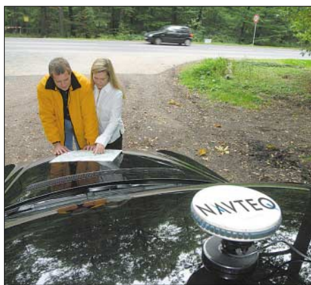
Bild 4: Eine pilzförmige GPS-Antenne gehört zur Standardausrüstung. Fotos: Navteq
