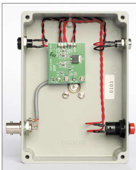
Bild 5: Professioneller Aufbau bis ins Detail: Blick auf die Fernspeiseweiche in der Antennenbasis.
