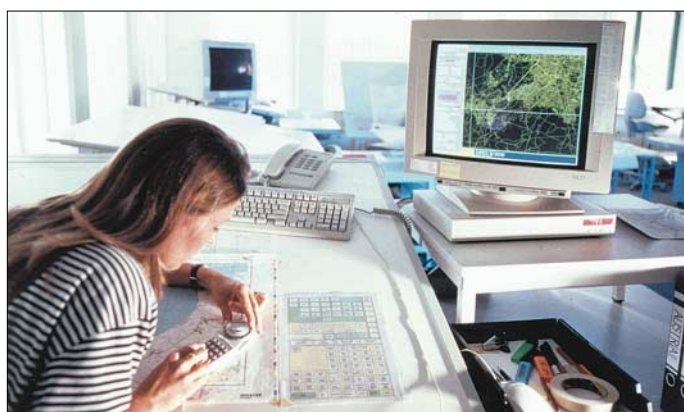
Bild 1: Früher war die Datenerfassung noch mit weit mehr Handarbeit verbunden, als es heute notwendig ist: Karten wurden gekauft und mit einer Scanmaus digitalisiert.
